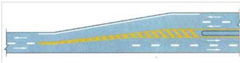
双向两车道改变为双向四车道
